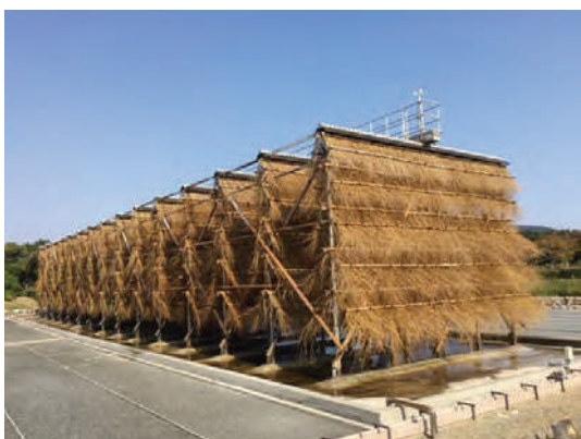
㉒ 赤穂市立海洋科学館・塩の国と水尾 復元塩田（流下式塩田の枝条架）
